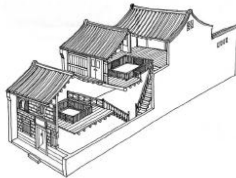
圖二、鹿港傳統店屋透視圖。樓井在室內，第二進二樓出口在第一進屋頂。資料來源：《台灣建築史》。
